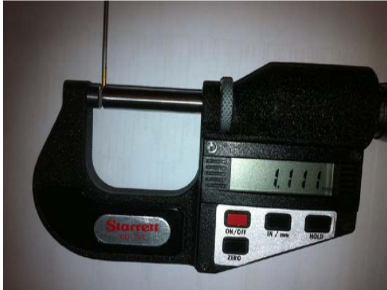
Εικόνα 5.5: Η εξωτερική διάμετρος ενός punch 1,0 mm, όπως μετρήθηκε με τη βοήθεια ψηφιακού μικρομέτρου.
